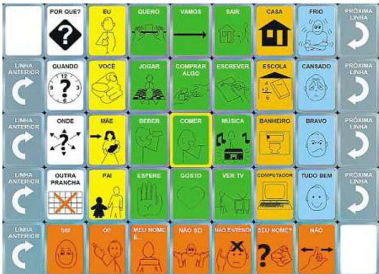
Sistema desenvolvido por alunos da PUC Minas, composto de um capacete e um painel na tela de um computador, possibilita a portadores de deficiência cerebral comunicar desejos e sensações
